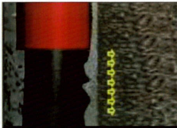
Figura 10 – Conforme a lama é forçada em direção a formação, sólidos filtrados se acumulam na parede do poço. Fonte: Karimi et al. (2011)
